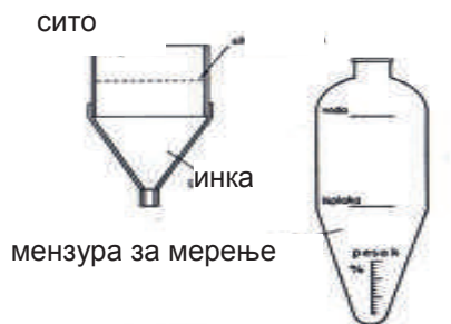
Сл. 156. Прибор за мерење на песок во исплуката
